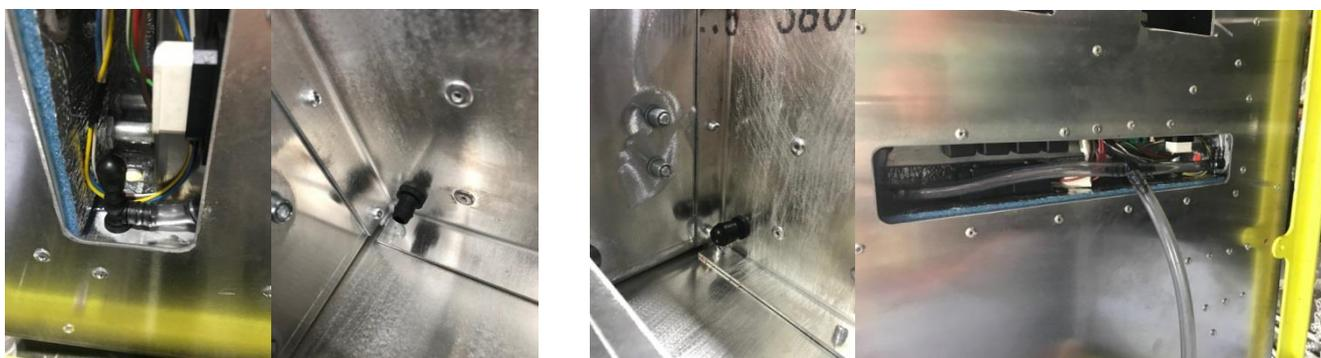
Для вывода конденсата под днище транспортного средства необходимо переставить заглушки на внешние концы сливных патрубков, одеть дренажный шланг из комплекта поставки на внутренние концы и вывести слив в необходимое место. При монтаже дренажной трубки необходимо обеспечить уклон и проконтролировать отсутствие ее заломов и загибов.
