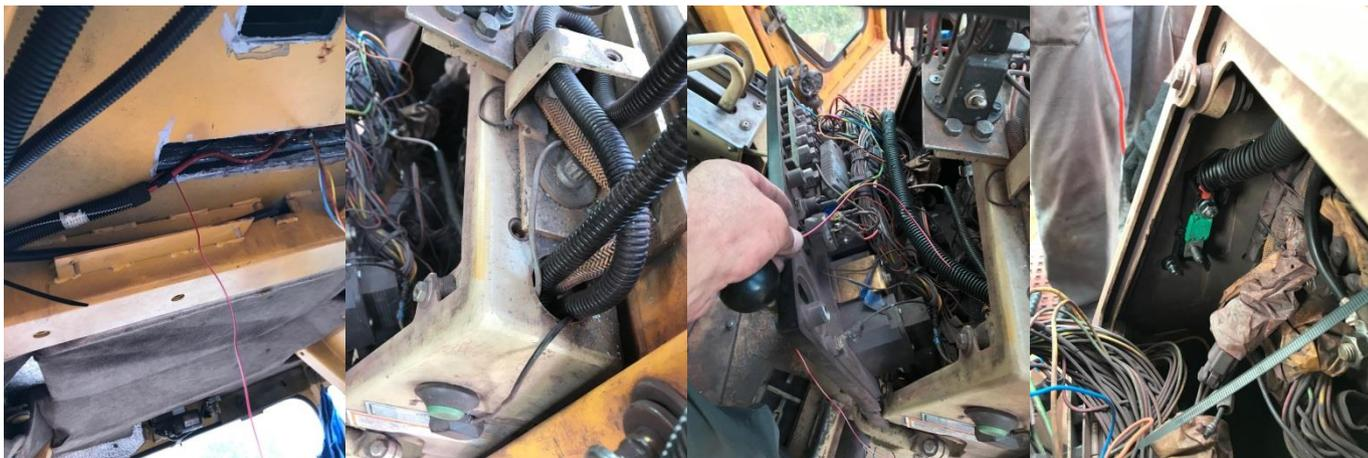
**ОСТОРОЖНО!** Все кабели и провода должны быть закреплены на элементах кузова и должны находиться в стороне от подвижных, нагретых и других элементов кузова и двигателя, способных вызвать повреждение.
