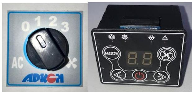
При использовании органа управления в виде переключателя скорости вентилятора испарителя компрессор кондиционера работает при включении одной из скоростей вентилятора испарителя. При установке переключателя скорости вентилятора в положение «0» кондиционер выключается. Положение «1» соответствует минимальной, «2» - средней «3» - максимальной скорости вентилятора испарителя.
