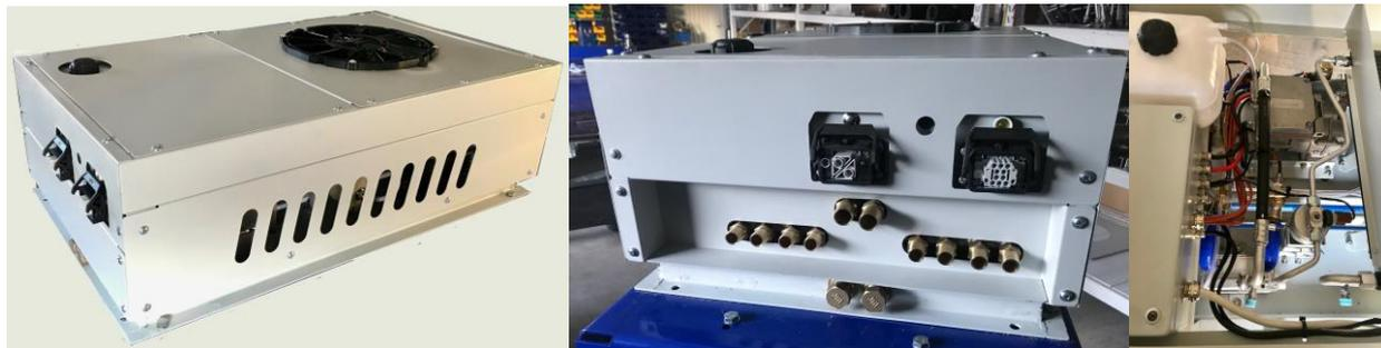
Система предназначена для обеспечения температурного режима в модулях аккумуляторных батарей электротранспорта. Температурный режим обеспечивается теплоносителем, циркулирующим между теплообменниками модулей аккумуляторов и системы за счет работы ее электрического насоса.
