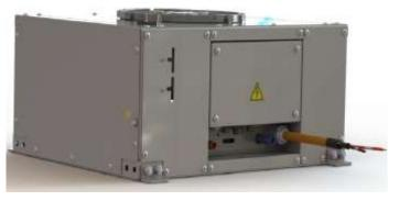
Система терморегулирования (СТР) обеспечивает температурный режим в блоках тяговых аккумуляторов с использованием жидкого теплоносителя, циркуляцию которого обеспечивает встроенный электронасос. СТР работает в режимах циркуляции, активного/пассивного охлаждения или подогрева теплоносителя.
